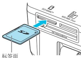
将一张存储卡插入插槽。
