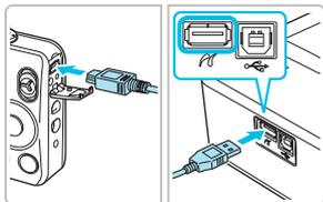
用数码相机附带的接口电缆（USB 电缆）将 SELPHY 连接到数码相机。
